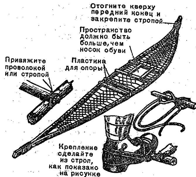
Рис. 33. Изготовление лыж-снегоступов из подручных средств
